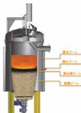
図4 ガス化発電装置
