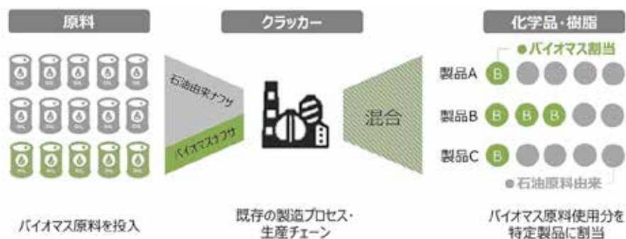
図9 バイオナフサを用いたバイオ化学品製造 19)
